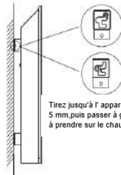
Retirez le radiateur du mur
